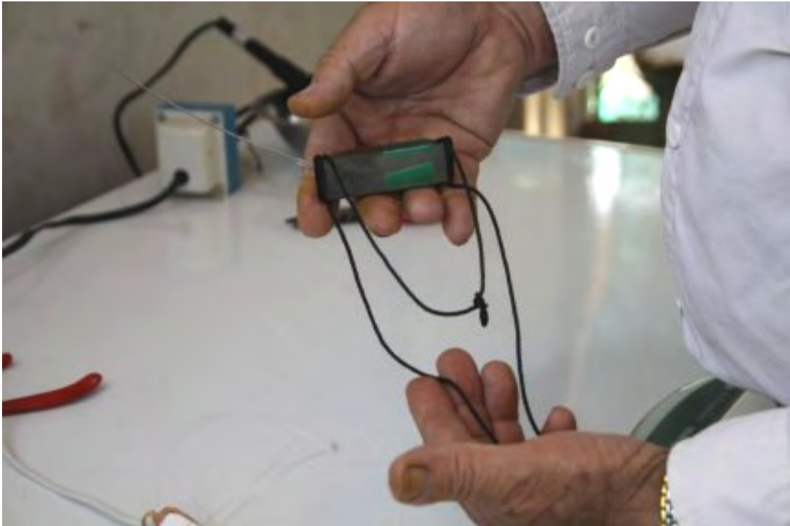
Arnés utilizado para fijar Radio Satelital en Cormorán Yeco.
