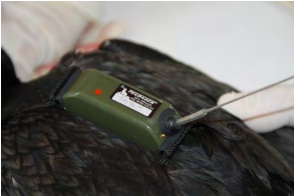
Radio Satelital utilizada para recolectar datos de distribución de Cormorán Yeco.
